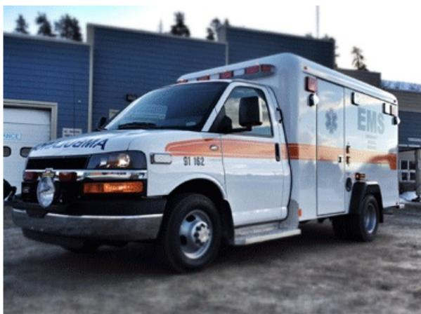
La sécurité et la visibilité ont été accrues grâce aux caractéristiques suivantes : rubans réflecteurs, phares antibrouillard, projecteur à faisceau étroit portatif, feux de secours plus brillants et une caméra tournée vers l'arrière qui permet au conducteur d'avoir une vue complète derrière le véhicule lorsqu'il recule.
