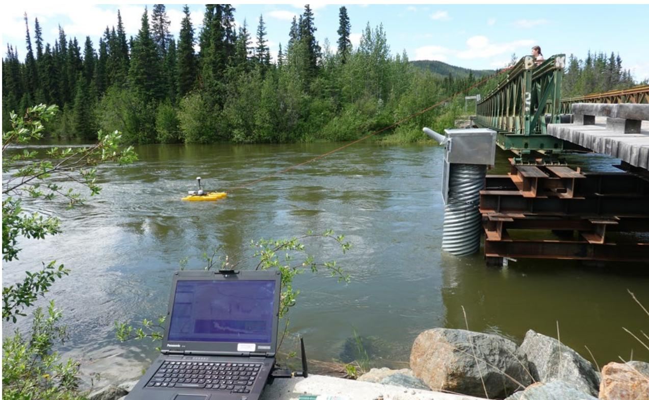
Haut débit mesuré au pont n° 1 de la rivière Ross par la station hydrométrique grâce à un profileur de courant à effet doppler
